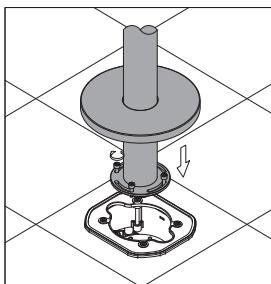
Аккуратно установите трубу с фиксатором в водопроводные отверстия в монтажной коробке. Затяните фиксатор винтами к монтажной коробке
