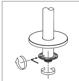
Накрутите фиксатор на трубу, а затем зафиксируйте винтом сбоку.
