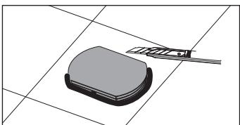
Отрежьте выступающую часть, загерметизируйте зазор между монтажной коробкой и облицовкой водонепроницаемым герметиком.
