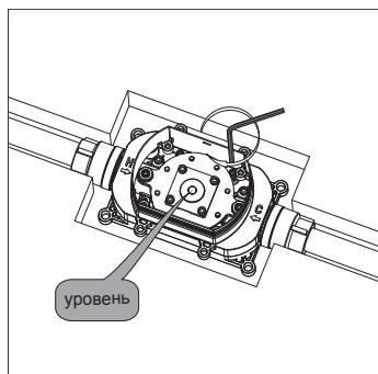
Установите монтажную коробку на место установки смесителя и отрегулируйте положение коробки с помощью датчика уровня.
