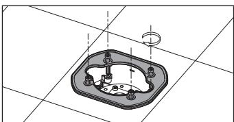
Закрепите водонепроницаемую пластину
