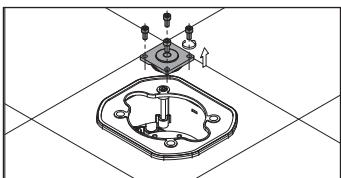
Открутите винты, извлеките пластину с датчиком уровня
