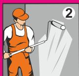
Обработайте основание грунтовочными составами БОЛАРС, соответствующими Вашему типу поверхности.
