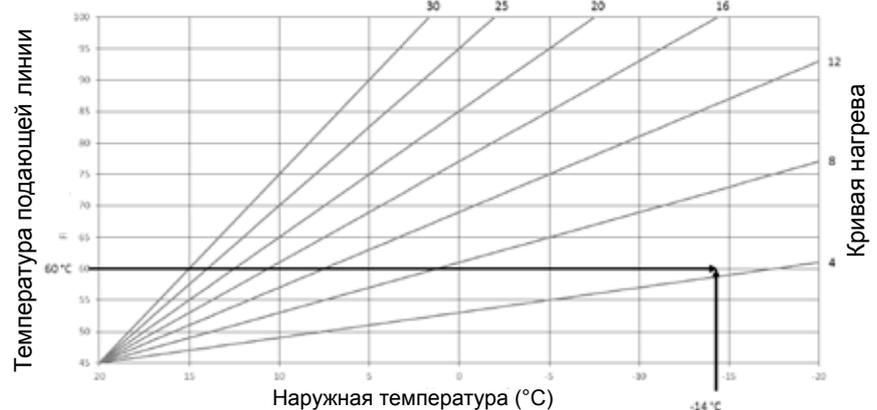
Для всех прочих условий измените наклон в соответствии с конкретной ситуацией. Крутизну характеристики необходимо всегда настраивать таким образом, чтобы при мин. наружной температуре достигалась макс. температура подающей линии радиатора отопления или контура отопления типа «теплый пол».
