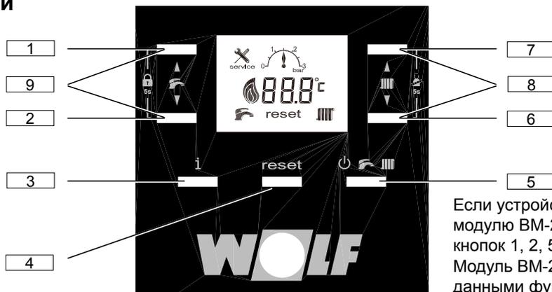
Если устройство подключено к модулю VM-2, то дисплей и функции кнопок 1, 2, 5, 6 и 7 отключены. Модуль VM-2 перенимает управление данными функциями.
