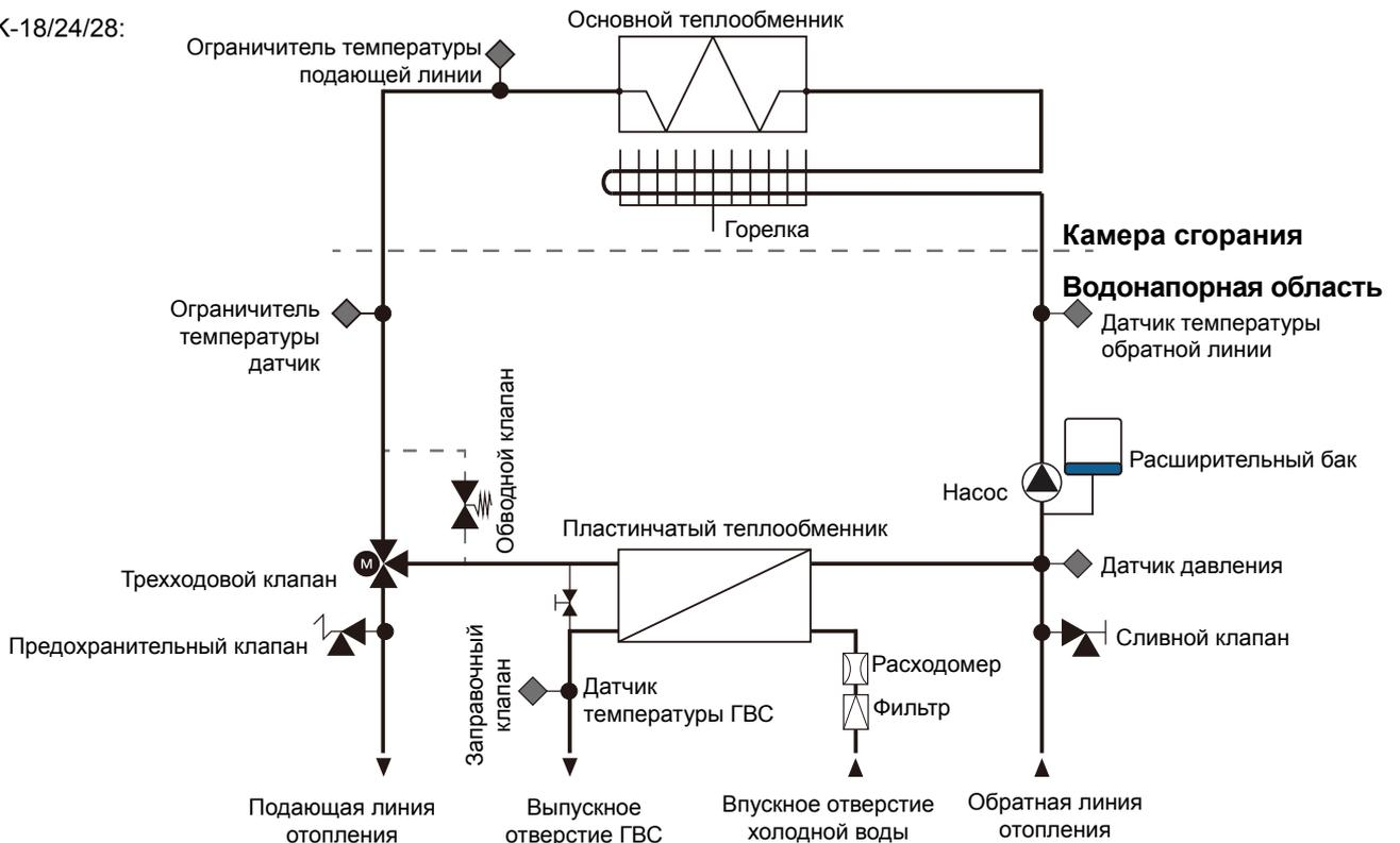
Теплообменник ГВС и датчик температуры подающей линии ГВС устанавливаются только в комбинированных котлах.
