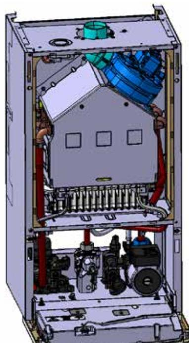
Подключите линию подачи газа к газовому соединению или компенсатору (рекомендуется) с помощью газового соединения G<sup>3/4</sup>" и одобренного герметического материала. Убедитесь, что линия подачи находится в ненапряженном состоянии.
