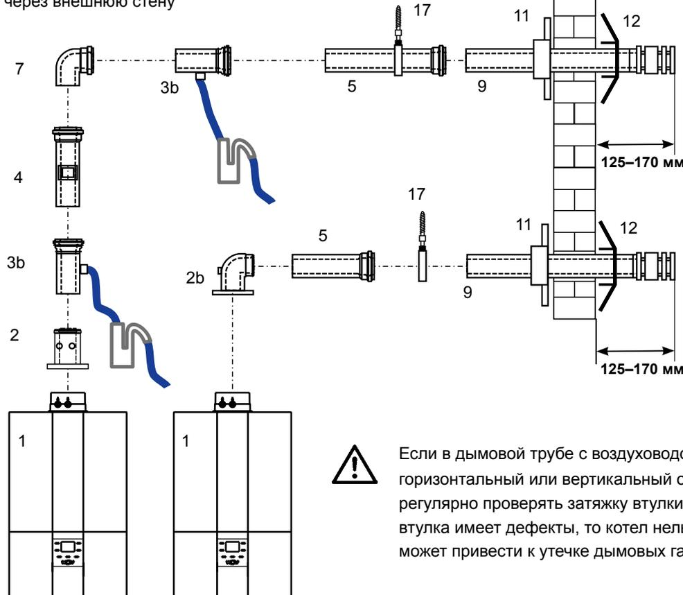
Если длина дымовой трубы с воздуховодом и дымоходом превышает 2,5 м при низкой потребности в обогреве, рекомендуется установить отвод конденсата, чтобы избежать повреждения газового котла от накопления влаги (см. принадлежности Wolf).
