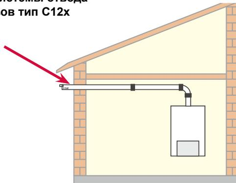
Горизонтальный проход через наружную стену (дымовая труба с воздуховодом и дымоходом)
