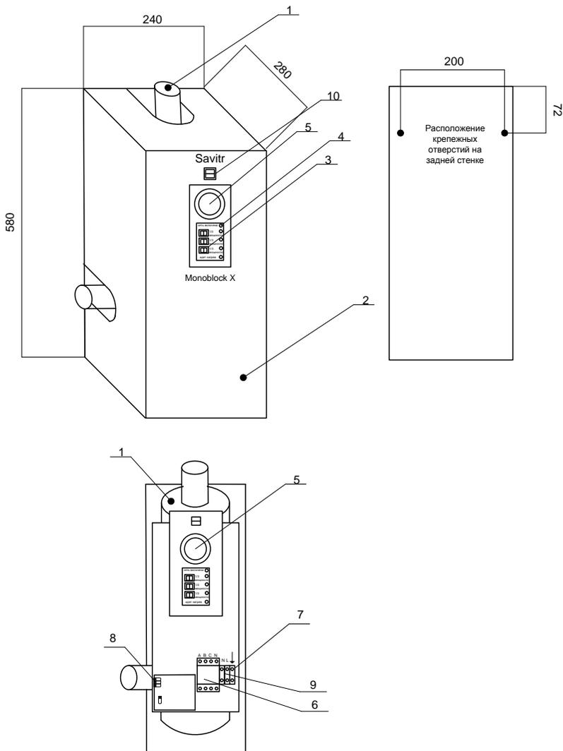
Водонагреватель электрической модели «Control X» состоит из водонагревателя 1, корпуса 2, клавиши выключателя котла 10, контактора 6, контроллера 4, колодки подключения циркуляционного насоса 8, колодки подключения цифровых датчиков температуры 5, клеммы заземления 7 и колодки подключения стабилизированного напряжения 220В 9. Внешний вид котла представлен на рис 2.
