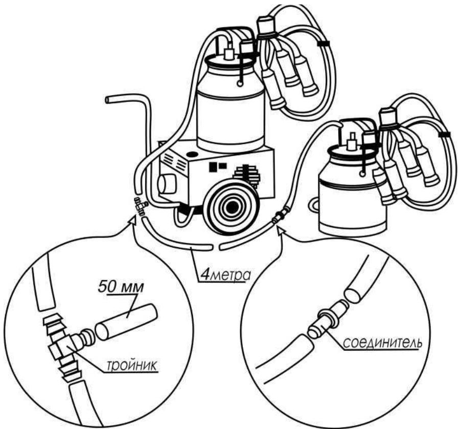
**Схема соединения доильных аппаратов
