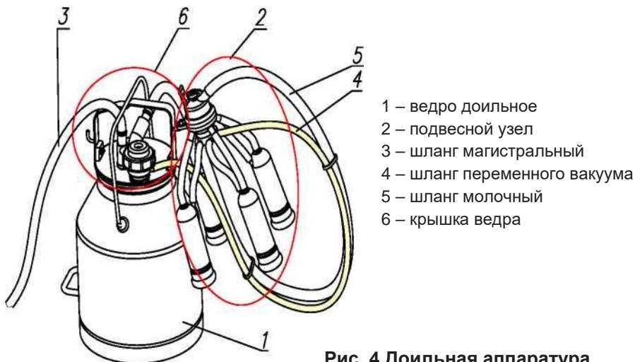
Рис. 4 Доильная аппаратура
