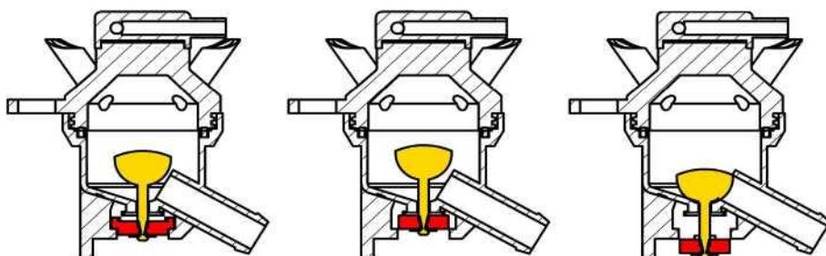
1 - во время промывки (шайбу 7 утопить и повернуть до фиксации, клапан 5 открыт)
