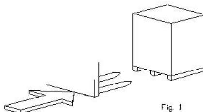
4.1. Транспортировка. Аппарат следует транспортировать при помощи погрузчика с вилочным захватом, при этом вилы должны быть расположены, как показано на рис.1
