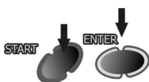
Чтобы не удерживать клавишу длительное время, нажмите клавишу **ENTER** во время измерения и одновременно отпустите обе клавиши (**START+ENTER**). Будет произведена блокировка клавиши **START**. Наличие напряжения на выходах прибора сигнализируется на дисплее знаком . Для остановки измерения нажмите клавишу **START** или **ESC**.
