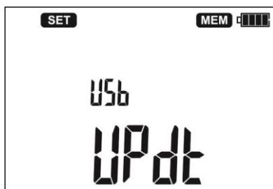
Подключите кабель от порта USB компьютера к разъёму USB измерителя.
