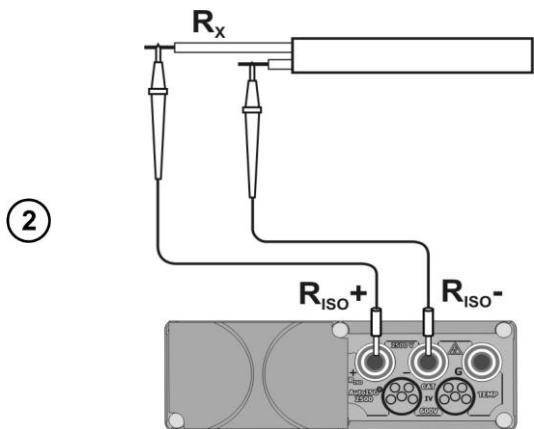
Подключите измерительные провода согласно рисунку.
