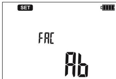
Время для расчёта коэффициентов составляет  $t_1=15$ сек. (30сек. для коэффициента **Pl**),  $t_2=60$ сек.,  $t_3=600$ сек.
