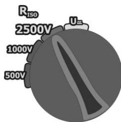
Установите поворотный переключатель в режим **R<sub>Iso</sub>** для одного из стандартных напряжений.
