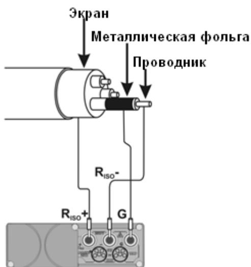
Таким же способом подключается разъём **G** при измерении сопротивления между двумя жилами к третей, не участвующей в процессе измерения.
