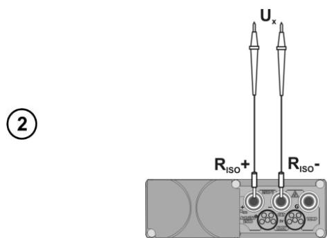
Подключите измерительные провода к источнику напряжения.
