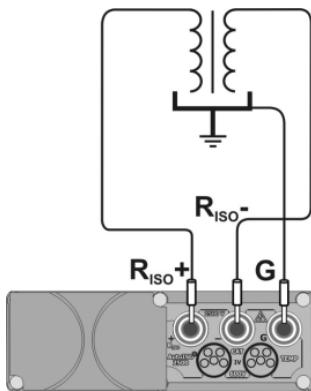
При измерении сопротивления между жилой кабеля и экраном, влияние поверхностных токов (особое влияние оказывают при сложных погодных условиях) устраняют соединением кусочка металлической фольги, навитого на изоляцию измеряемой жилы, с разъёмом **G**.
