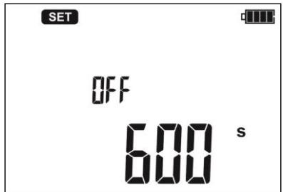
Функция автоматического выключения **OFF** через заданное время приведёт к отключению неиспользуемого прибора.
