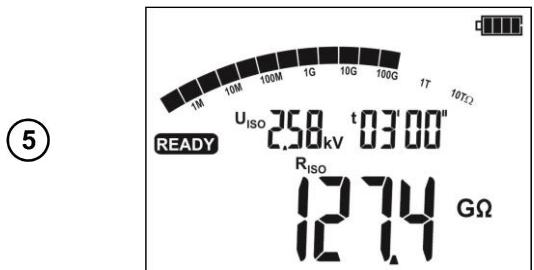
После окончания измерения на дисплее отобразится величина измерения изоляции.
