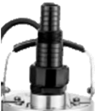
Универсальный фитинг позволяет использовать трубы/шланги диаметром 32мм (1 1/4") или 25мм (1"). Шланг рекомендуется дополнительно закрепить хомутом.
