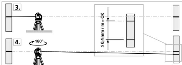
**!** Pokud jsou body A2 a A3 od sebe vzdáleny více než 0,4 mm / m, je nutné provést kalibraci. Spojte se s Vaším specializovaným prodejcem nebo využijte servisního oddělení společnosti UMAREX-LASERLINER.
