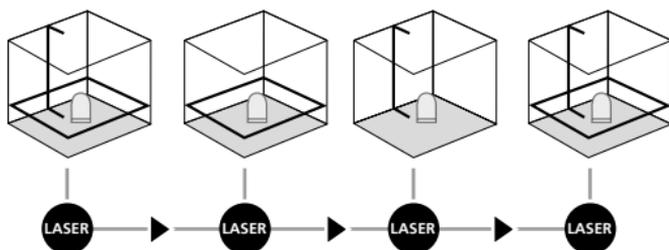
**!** Za vodoravno in navpično niveliranje je treba sprostiti transportno varovalo. Takoj, ko je naprava izven samodejnega območja niveliranja, ki znaša 5°, začnejo laserske linije utripati in LED-lučka zasveti rdeče. Napravo postavite tako, da ne bo znotraj območja niveliranja. LED-lučka bo znova preklopila na zeleno in laserske linije bodo stalno svetile.
