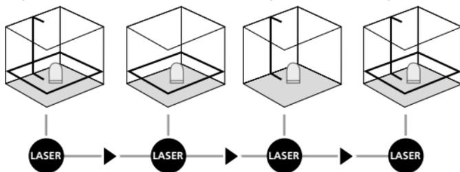
Для горизонтального и вертикального нивелирования необходимо снять с блокировки фиксатор для транспортировки. Постоянно горит зеленый светодиод. Как только прибор окажется за пределами автоматического диапазона нивелирования, равного 5°, лазерные линии и светодиод начинают гореть красным цветом. Позиционировать прибор так, чтобы он находился в пределах диапазона нивелирования. Светодиод снова изменяет свой цвет на зеленый, а лазерные линии светятся постоянно.
