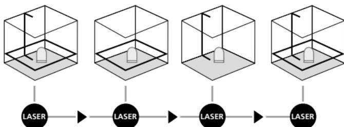
Для горизонтального і вертикального нівелювання необхідно розфіксувати транспортне стопоріння. Постійно світиться зелений світлодіод. У разі виходу за межі діапазону автоматичного нівелювання, що становить  $5^\circ$ , лазерні лінії починають блимати, а світлодіодний індикатор загоряється червоним світлом. Розташуйте прилад так, щоб потрапив у межі діапазону автоматичного нівелювання. Світло знову змінить колір на зелений, а лазерні лінії загоряться сталим світлом.
