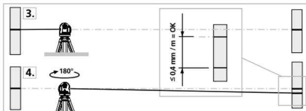
**!** Če sta A2 in A3 več kot 0,4 mm / m narazen, je treba napravo umeriti. Stopite v stik s prodajalcem ali pa se obrnite na servisni oddelek podjetja UMAREX-LASERLINER.
