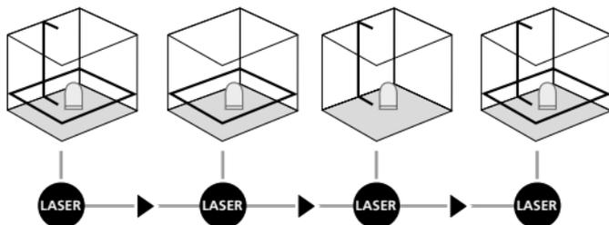
**!** Pentru nivelarea orizontală și verticală, siguranța pentru transport trebuie să fie îndepărtată. LED-ul luminează constant verde. De îndată ce aparatul se află în afara domeniului de nivelare automată de 5°, razele laser pâlpâie iar LED-ul luminează roșu. Poziționați aparatul astfel încât acesta să se afle în cadrul domeniului de nivelare. LED-ul se aprinde din nou verde iar razele laser luminează constant.
