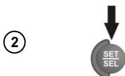
Используйте клавишу **SET/SEL** для выбора номера **Bank** или ячейки **Cell** для изменения номера.
