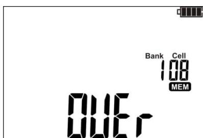
При попытке записать результаты измерения в заполненную ячейку, на дисплее отобразится следующий символ:
