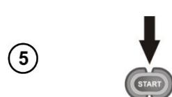
Нажмите клавишу **START** для повторного измерения без отключения измерительных проводов.
