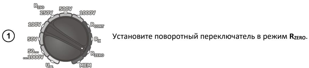
Установите поворотный переключатель в режим  $R_{ZERO}$ .
