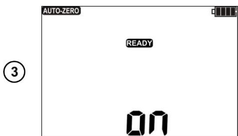
**AUTO-ZERO** и **ΩP** отображены на дисплее, подтверждающие завершение процесса компенсации (калибровки) сопротивления измерительных проводов.
