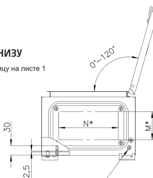
Элемент для подключения заземления. Винт М6
