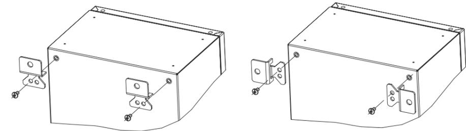
5 Закрепите шкаф на стене. При фиксации шкафа без использования кронштейнов, блокируйте отверстия для установки кронштейнов с внутренней стороны шкафа, используйте винты М6х12.
