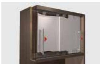
Очень простой монтаж: в верхнем щите и днище шкафа фрезеруются по два паза, в которые запрессовываются ходовые и направляющие профили, предварительно нарезанные в размер.
