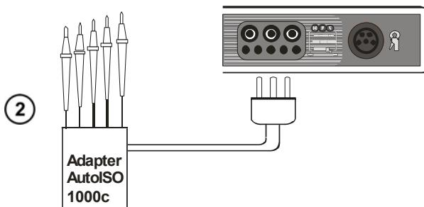
Измеритель MPI-520 автоматически определит подключение адаптера AutoISO-1000c и добавит необходимые возможности настройки.
