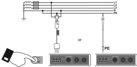
Подключите измеритель согласно схеме, представленной на рисунке и приложите палец к электроду прикосновения на 1 секунду. Если на PE проводнике будет обнаружено напряжение, на дисплее отобразится сообщение **PE!** (ошибка подключения, на PE проводнике обнаружено опасное напряжение). Данное сообщение будет сопровождаться продолжительным звуковым сигналом. Данная функция активна во всех режимах, связанных с измерением параметров УЗО или параметров петли короткого замыкания.
