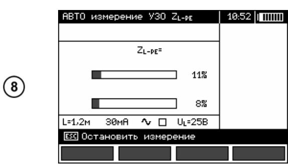
Для начала измерения нажмите клавишу **START**. Некоторые измерения могут привести к выключению УЗО. Для измерения следующих параметров достаточно привести УЗО в рабочий режим.
