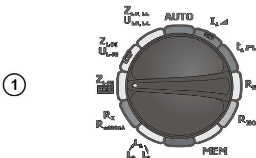
Установите поворотный переключатель в режим **ZL-PE RCD**.
