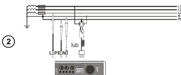
Подключите измеритель согласно схеме:
