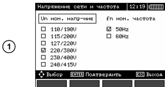
Используя клавиши  $\blacktriangle \blacktriangleright$ , выберите параметр, требующий изменений, а клавишами  $\blacktriangle \blacktriangledown$  установите номинальные значения напряжения и частоты сети.
