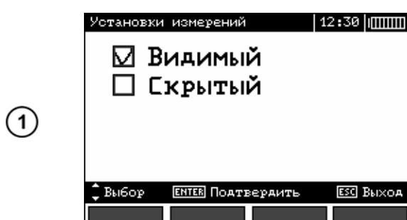
Настройка позволяет включить или выключить строку с параметрами, отображаемую на дисплее. Используя клавиши  $\blacktriangle$  и  $\blacktriangledown$ , установите необходимый вариант.
