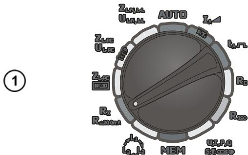
Установите поворотный переключатель в режим  $R_x$ ;  $R_{\pm 200mA}$ .
