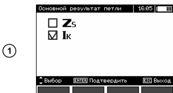
Используя клавиши  $\blacktriangle \blacktriangledown$  выберите параметр для отображения на главном экране:
