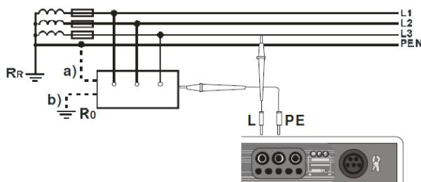
Схемы подключения для разных типов сетей:
