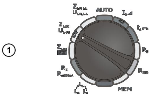
Установите поворотный переключатель в режим  $Z_{L-PE}/U_{L-PE}$ .
