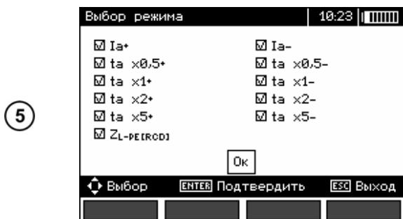
Нажмите **F2 РЕЖИМ** для установки измеряемых параметров.
