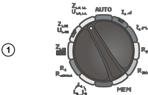
Установите поворотный переключатель в режим Z<sub>L-N,L-L</sub>/U<sub>L-N,L-L</sub>.
