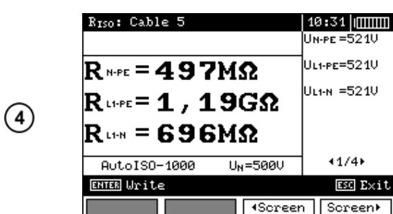
Нажмите **START** для начала измерения. Будет подано измерительное напряжение на первую пару проводов.
