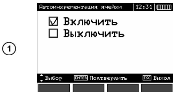
Используя клавиши  $\blacktriangle$   $\blacktriangledown$ , выберите необходимый режим. Автоинкрементация ячеек памяти позволяет автоматически сохранять в следующую свободную ячейку памяти результаты измерений.
