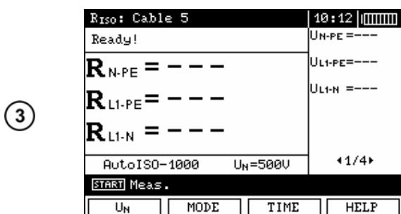
Нажмите **F1**  для установки измерительного напряжения.
