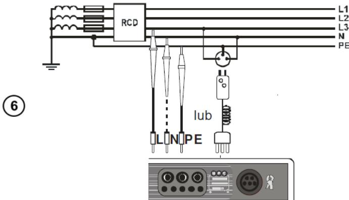
Подключите измеритель согласно схеме.
