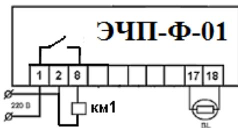
Рис 2. Схема включения
