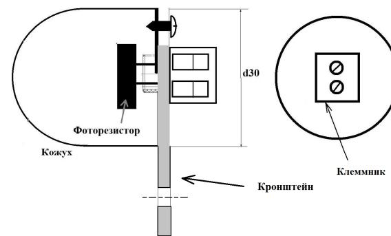
Рис. 3. Схема сборки фотодатчика.
