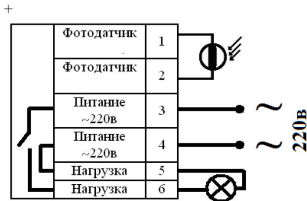
Рис. 3. Типовая схема подключения фотореле к сети 220в.
