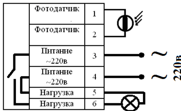
Рис. 2. Схема сборки фотодатчика.
