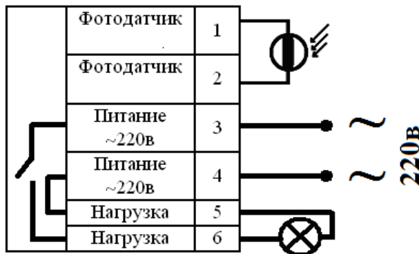
Рис. 2. Схема сборки фотодатчика.
