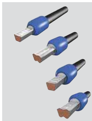
Образование трещин на сторонах. Расщепление сторон
