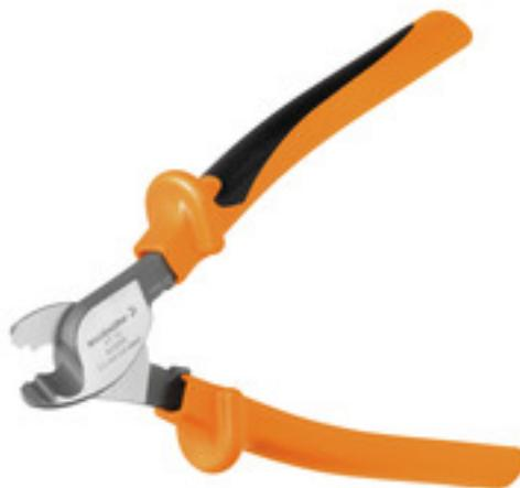
Режущие инструменты для проводов наружным диаметром до 8, 12, 14 и 22 мм. Особая геометрия лезвия обеспечивает резку медных и алюминиевых проводов без пережатия и с минимальным физическим усилием. Режущие инструменты также поставляются с защитной изоляцией до 1000 В, прошедшей испытания VDE и GS, в соответствии со стандартом EN/IEC 60900.
