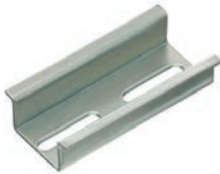
TS 35/15 мм согласно EN 50022 (s = 1.5 мм)
