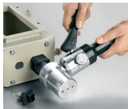
Пробивка отверстий для различных промышленных разъемов Ethernet.
