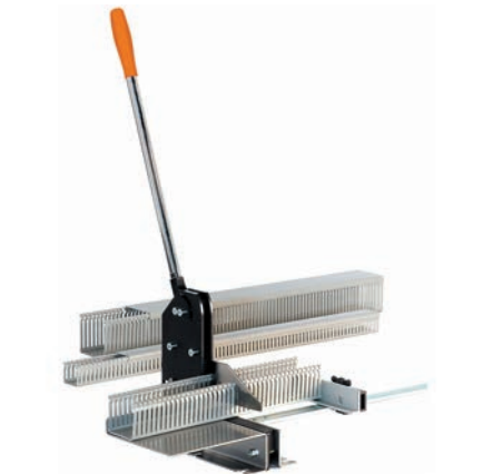
Нож с ручным управлением для резки проводных каналов и оболочек шириной до 125 мм. Резка без заусенцев или отходов. Продольный упор (1000 мм) с направляющей для точного регулирования угла. Блок настольного типа для крепления на автоматизированных или аналогичных рабочих местах. Закаленные режущие кромки, изготовленные из специальной стали.
