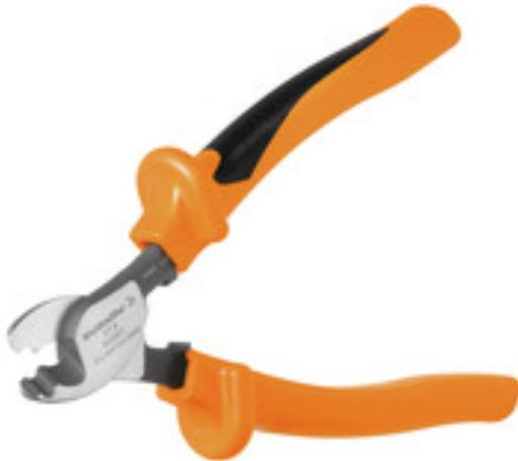
Режущие инструменты для проводов наружным диаметром до 8, 12, 14 и 22 мм. Особая геометрия лезвия обеспечивает резку медных и алюминиевых проводов без пережата и с минимальным физическим усилием. Режущие инструменты также поставляются с защитной изоляцией до 1000 В, прошедшей испытания VDE и GS, в соответствии со стандартом EN/IEC 60900.
