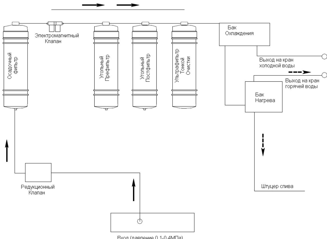
VATTEN PP – осадочный фильтр механической очистки (грубая фильтрация исходной воды - отфильтровывается грязь, песок, примесь, ржавчина и т. д.).
