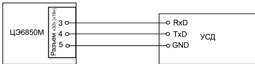
Рисунок 4.6 – Схема подключения интерфейсных линий EIA232
