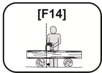
ходе распиловки. Позвольте цепи работать свободно, только слегка применяя давление, используя зубчатый упор (8) как рычаг.
