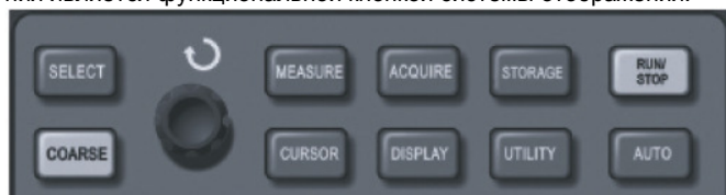
Рисунок 2-21. Функциональная кнопка системы регистрации (DISPLAY – отображение)
