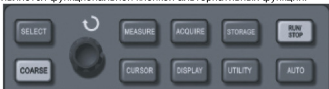
Рисунок 2-23. Функциональная кнопка системы регистрации (UTILITY – вызов альтернативных функций)
