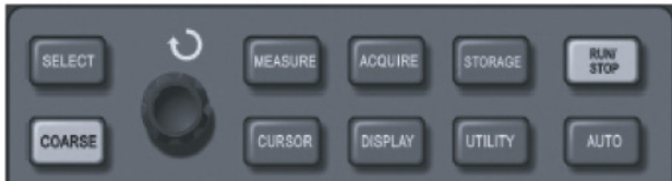
Рисунок 2-24. Функциональная кнопка системы регистрации (автоматические измерения).
