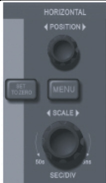
Рисунок 2-11. Интерфейс системы горизонтальной развертки
