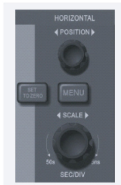
Рисунок 1-10. Зона управления горизонтальной разверткой на передней панели
