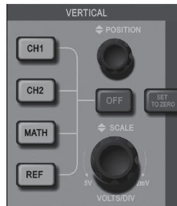
Рисунок 1-9. Зона управления вертикальной разверткой на передней панели
