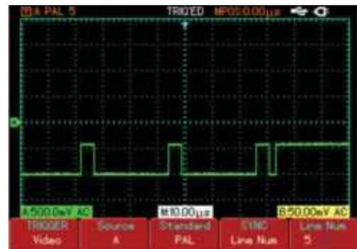
Рис. 3-9: Запуск по строкам видеосигнала
