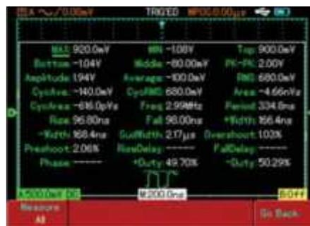
Рис. 2-23: Отображение всех параметров
