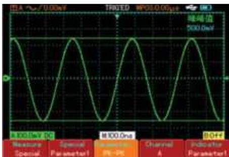
Рис. 2-22: измерение выбранного параметра
