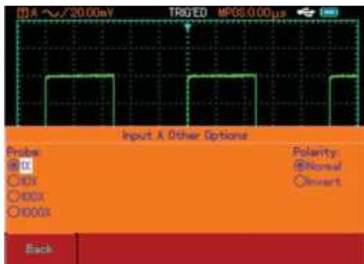
Рис. 1-4: Установка коэффициента ослабления щупа.
