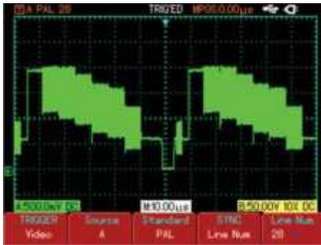
Рис. 2-17: Запуск по видеосигналу: синхронизация по строкам
