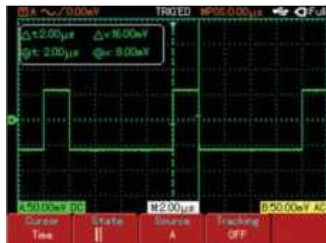
Рис. 3-6: Измерение ширины импульса с помощью курсоров.
