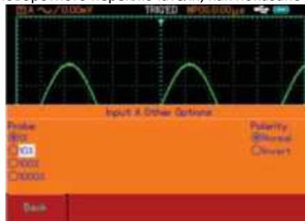
Рис. 2-11: Настройка коэффициента ослабления щупа
