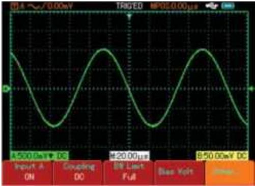
Рис. 2-15: Установка полярности осциллограммы (обратная)
