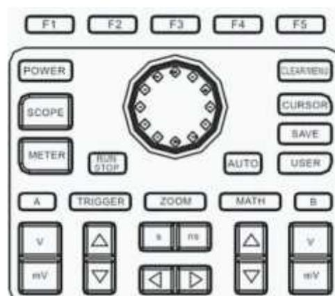
Рис. 7-1: Панель управления осциллографом
