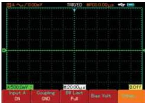
↑ установка заземления
