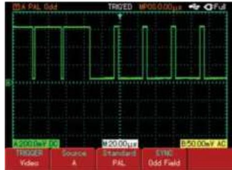
Рис. 3-8: Запуск по полям видеосигнала
