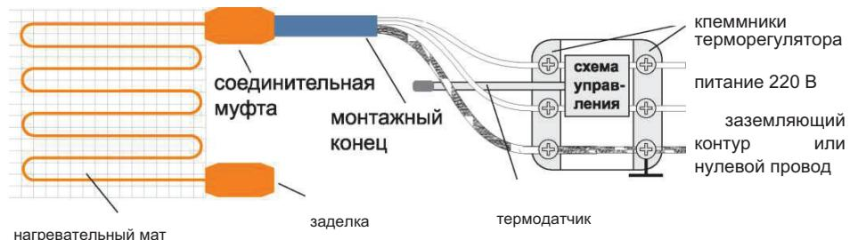
Изолированные белые провода монтажного конца соединены с нагревательными жилами кабеля и подключаются к терморегулятору. Провод экранирующей оплётки монтажного конца соединен с защитным экраном нагревательного кабеля. Этот провод необходимо подключить к заземляющему контуру здания (или нулевому проводу).
