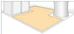
1. Определить площадь обогрева и выбрать мат, площадь которого примерно совпадает с площадью обогрева.
