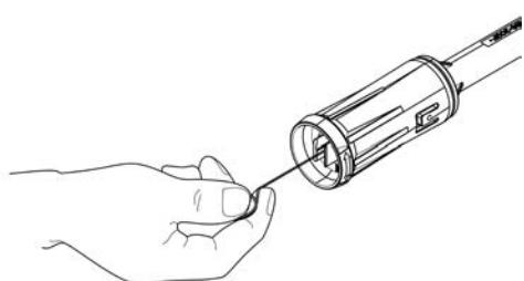
Снимите с пистолета распылитель. Удалите загрязнение из отверстия форсунки и сполосните.
