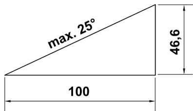
Для обеспечения достаточной смазки двигателя внутреннего сгорания при работе устройства на склонах необходимо соблюдать дополнительные сведения в имеющейся инструкции по эксплуатации двигателя внутреннего сгорания.
