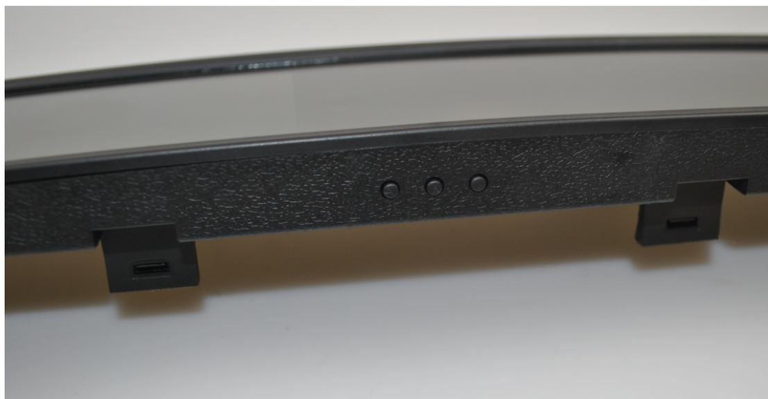
На нижней поверхности зеркала расположены три кнопки управления
