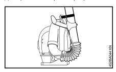
Прикрепить нагнетательную трубу лентой-липучкой к отверстию спинной пластины
