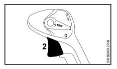
Привести в действие рычаг газа – поворотная кнопка клапана воздушной заслонки автоматически переходит в положение "Т\*
