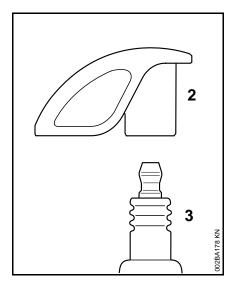
Закрутить свечу зажигания (3) и штекер свечи (2) плотно прижать к свече зажигания (3)
