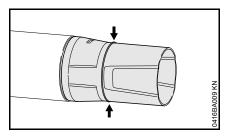
Во время работы передняя часть насадки изнашивается ввиду скользящего контакта с поверхностью земли. Насадка является быстроизнашивающейся деталью и подлежит замене по достижении индикатора износа.
