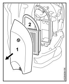
Снять крышку фильтра (1) и воздушный фильтр (2)
