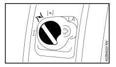
Поворотную кнопку клапана воздушной заслонки повернуть в положение )\(
