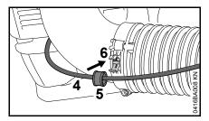
Зафиксировать тросик акселератора (4) с помощью втулки (5) в хомуте шланга (6)
