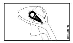
Переводной рычаг привести в положение 0 – двигатель останавливается – переводной рычаг после приведения в действие отскакивает назад
