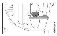
Перед заправкой топливом очистить крышку бака и прилегающую поверхность, чтобы в бак не попала грязь
