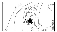
Сильфон ручного топливного насоса нажать минимум 5 раз – даже в том случае, если он еще заполнен топливом.
