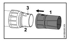
Надеть насадку (1) на нагнетательную трубу (2) и зафиксировать в цапфах (3)
