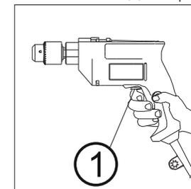
Для выхода из режима длительной и непрерывной работы необходимо повторно коротко нажать на кнопку выключателя 1 и затем отпустить ее. Кнопка фиксации положения выключателя автоматически возвращается в свое исходное положение.
