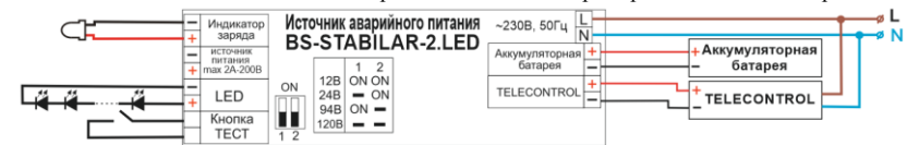
Рис. 2 Схема подключения BS-STABILAR2-83-B1-LED для аварийного светового прибора в непостоянном режиме:
