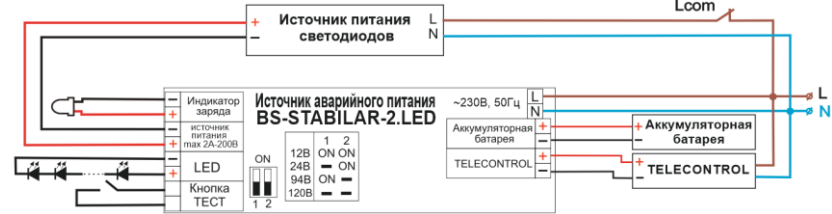
Рис. 1 Схема подключения BS-STABILAR2-83-B1-LED для аварийного светового прибора в универсальном режиме:
