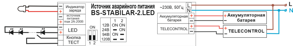
Рис. 2 Схема подключения BS-STABILAR2-81-B2-LED для аварийного светового прибора в непостоянном режиме:
