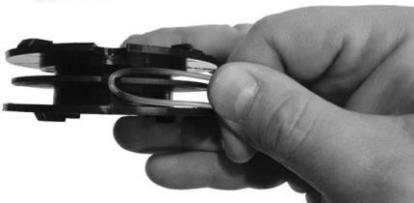
Намотайте корд плотно с натягом в канавку катушки. Направление намотки указано стрелкой (**WIND CORD**) на катушке.
