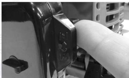
**Рис.9 Закрытие воздушной заслонки**
