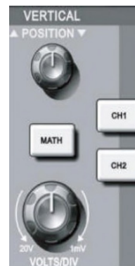
Рисунок 1-9 Зона управления вертикальной разверткой на передней панели
