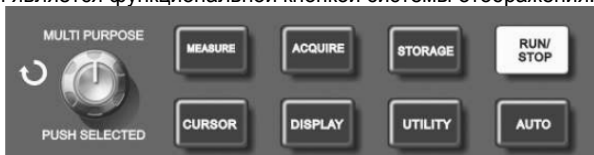
Рисунок 2-20 Функциональная кнопка системы регистрации (DISPLAY – отображение)
