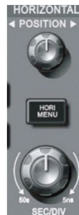
Рисунок 1-10 Зона управления горизонтальной разверткой на передней панели
