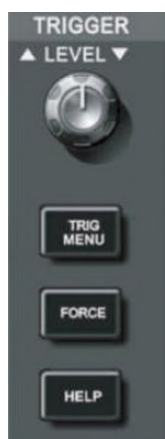
Рисунок 1-11 Зона управления запуском на передней панели
