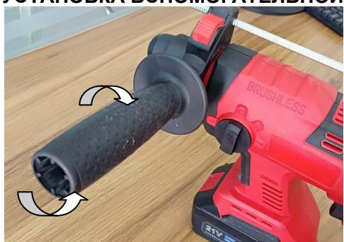
**Предупреждение.** Используйте инструмент с правильно установленной вспомогательной ручкой. Ослабьте вспомогательную ручку, отвинтив ее. Наденьте зажим вспомогательной ручки на воротник за патроном. Поверните боковую ручку в желаемое положение и затяните ручку.
