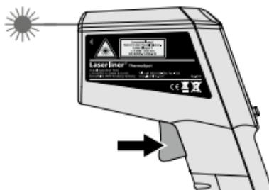
Отпустить кнопку, как только пятно излучения лазера попадет на нужный участок измерений. Результат измерения удерживается на экране.
