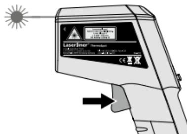
Після того, як бажане місце виміру визначається лазерним контуром, відпустити кнопку. Виміряне значення зафіксується.
