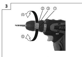
Проверьте правильность установки переключателя крутящего момента шпинделья. При использовании инструмента как шуруповерта, установите одну из цифр «1, 2, 3...18» на переключателе или черную отметку на треугольный значок на внешнем корпусе инструмента. При использовании инструмента в качестве дрели направьте значок ⌂ на переключателе на треугольный значок на внешнем корпусе инструмента.
