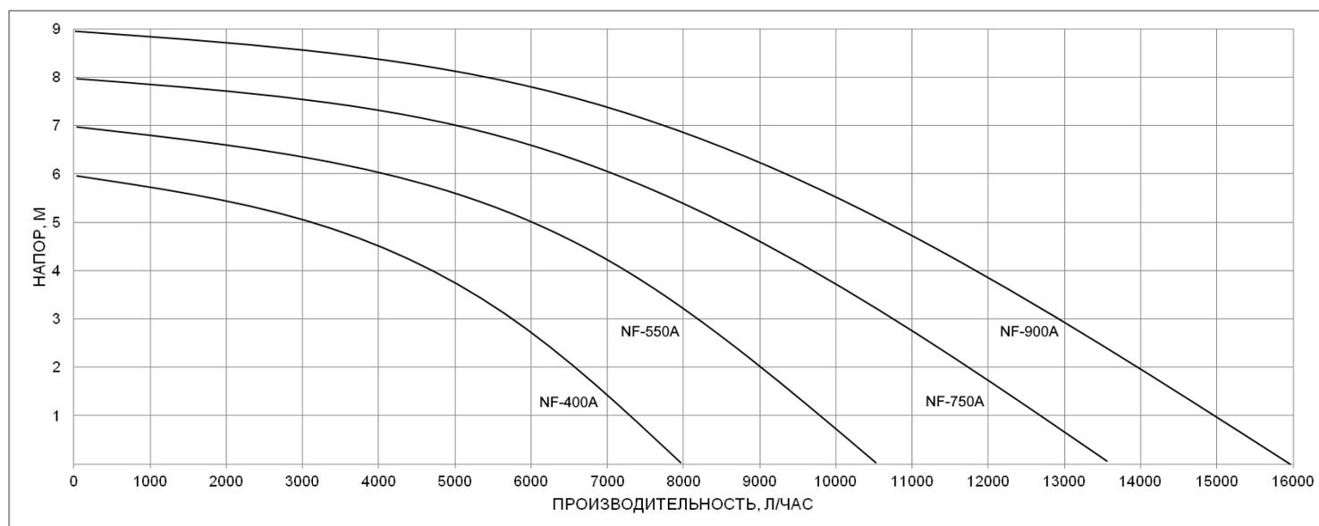
Приведенные характеристики справедливы при использовании патрубка G 1 1/2" и трубопровода с диаметром условного прохода DN40, а так же с минимальными сопротивлениями потоку воды в напорной магистрали, при номинальном напряжении питания 220 В.
