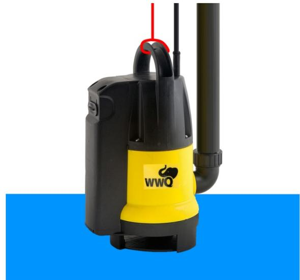
4.4. В верхней части кожуха расположена рукоятка для переноски и подвешивания насоса. Встроенный поплавковый выключатель автоматически включает и отключает насос в зависимости от уровня отводимой воды. В автоматическом режиме интервал между включением и отключением насоса со встроенным поплавковым выключателем составляет примерно 10 см. и регулировке не подлежит (рис. 2).
