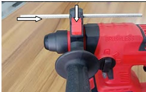
Ваша глубина сверления может быть предварительно установлена и / или повторена с помощью ограничителя глубины. Вставьте необходимое сверло. Вставьте ограничитель глубины в отверстие вспомогательной ручки и установите необходимую глубину.
