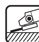
**SCHLEIFEN:** Die besten Ergebnisse werden mit einem Winkel von 30° bis 40° erreicht zum Schleifen, 15° zum Veredeln. Bewege die Maschine hin und her mit leichter Druck auf diese Weise wird das Werkstück nicht zu heiß, keine Verfärbung erfolgt und keine Kämme entstehen.
