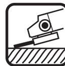
**SCHLEIFEN:** Die besten Ergebnisse werden mit einem Winkel von 30° bis 40° erreicht zum Schleifen, 15° zum Veredeln. Bewege die Maschine hin und her mit leichter Druck auf diese Weise wird das Werkstück nicht zu heiß, keine Verfärbung erfolgt und keine Kämme entstehen.
