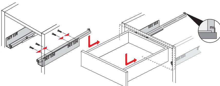
Количество используемых шурупов зависит от общего веса, типа шурупов и качества материала корпуса.
