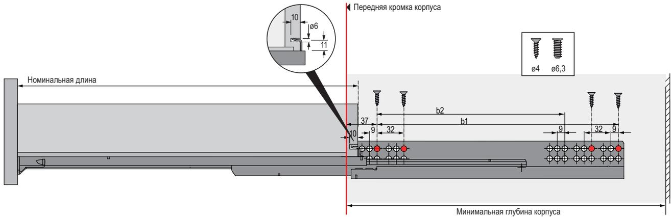
Данные размеры предусматривают зазор передней панели и корпуса, равный 4 мм. Толщина амортизаторов для передней панели также должна учитываться.
