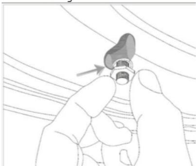
2. Накрутите датчик колпачок на ниппель автомобиля.
