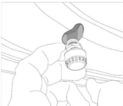
4. Плотнo зафиксируйте противокражную гайку с датчиком с помощью ключа.
