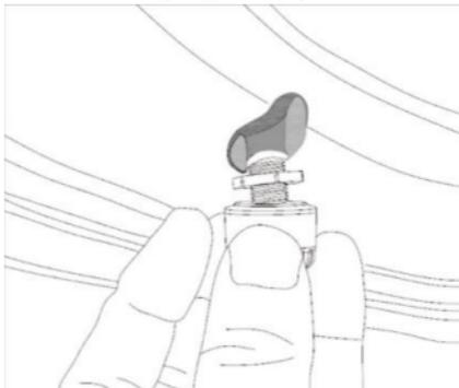
3. Подтяните противокражную гайку к датчику колпачку
