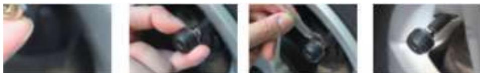
1 шаг - Закрутите защитную гайку по часовой стрелке.
