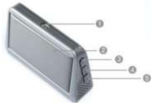
1. Разъем для подключения Микро USB для зарядки аккумулятора.
