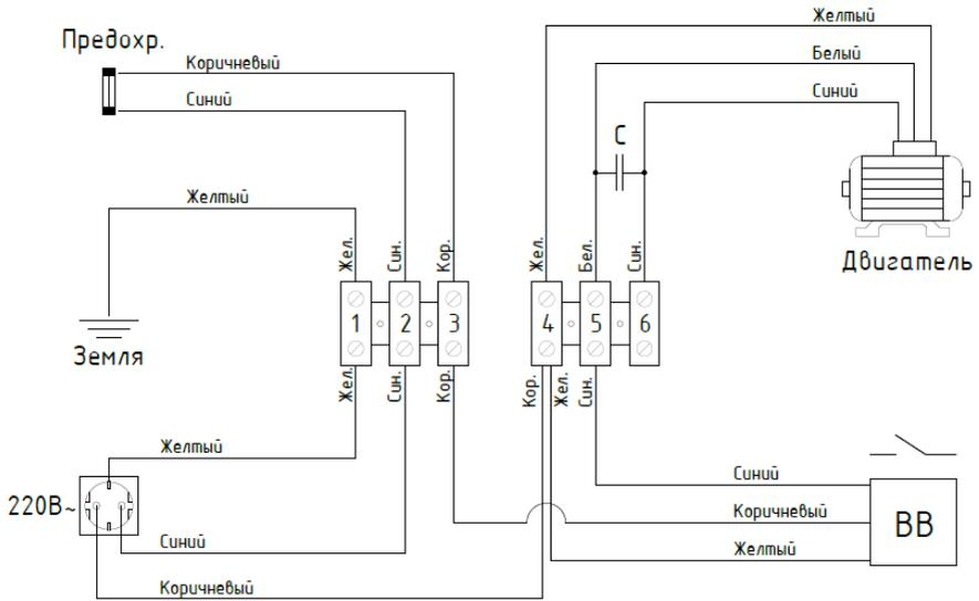
Рисунок Г.2 – Схема изделия с кнопкой включения/выключения
