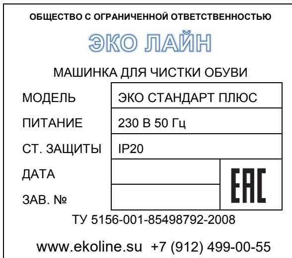
Рисунок 2 – Пример маркировочной таблички
