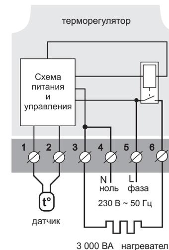
Схема 1. Схема подключения и упрощенная внутренняя схема
