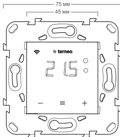
Рисунок 1. Габаритные размеры
